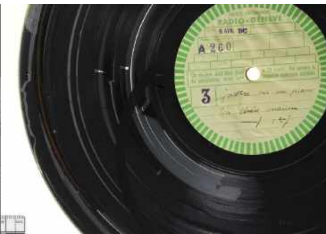
Simplat/Simplex, Radio-Genève, A260-2, 1942. Macrophotograph of gelatin coating peeling away. Quatre sur un piano, La chère maison, 6 April 1942.
