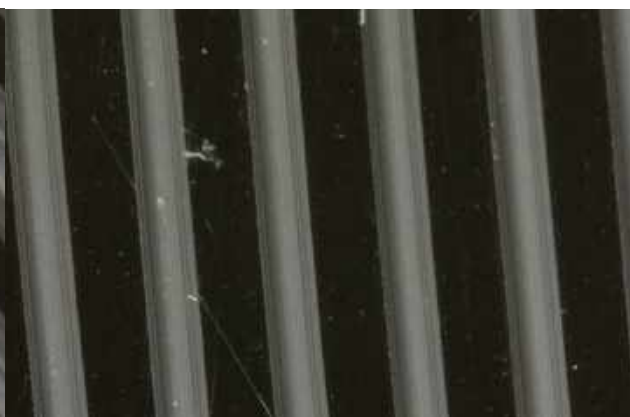
Simplat/Simplex, Radio-Lausanne, 88VII, 1938. Groove walls striations. USB micrograph, 250x. Farinet ou l'or dans la montagne, radio play, 6 September 1938.
