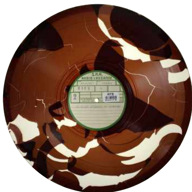
Gevaphone, Radio-Lausanne, 8632, 1942. Complete peeling of the coating layer. Le quart d'heure du sportif , 18 September 1942.
