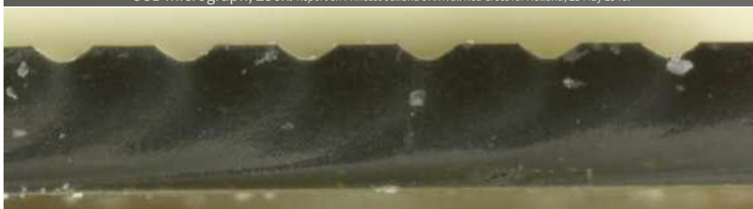
Thorens 3rd generation green, Radio-Genève, DN4626, 1946. Stratigraphy, cross-section. U-shaped cut. USB micrograph, 250X. Chœur d'enfants de l'Institut Jaques-Dalcroze, 26 June 1946.
