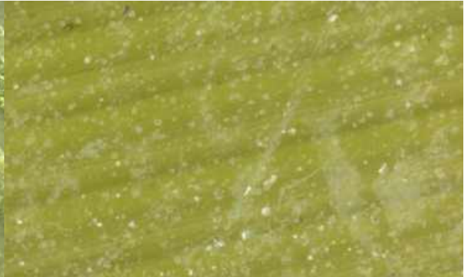
Thorens 3rd generation green, Radio-Lausanne, 26411, 1947. Coating reverse side, white residues. USB micrograph, 250X. La chaîne du bonheur chez Thorens, 10 December 1947.
