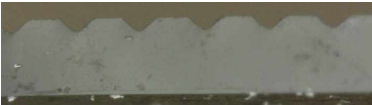
Thorens 3rd generation dark green, Radio-Lausanne, 23677, 1947. Stratigraphy, cross-section. V-shaped cut. USB micrograph, 250x. Forum Radio-Lausanne : la situation des ouvriers dans le monde, 28 April 1947.
